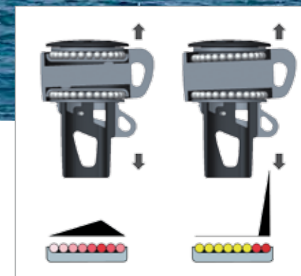
Der Lastverteiler schützt vor Punktbelastung einzelner Lagerkugeln!
